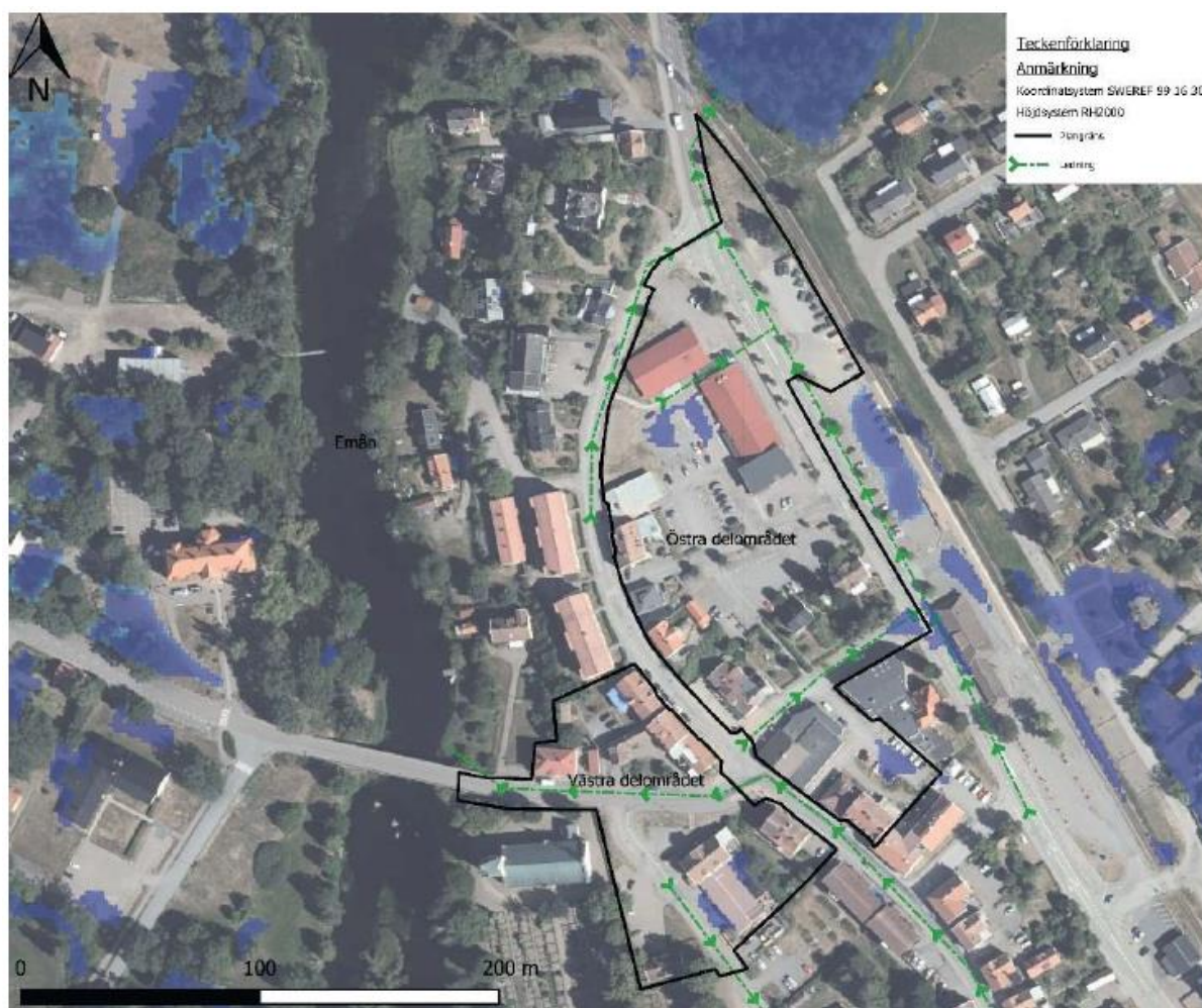
Figur 3. Huvudledningar och lågpunkter redovisade via SCALGO-Live för ett nederbördstillfälle om 30 mm.
