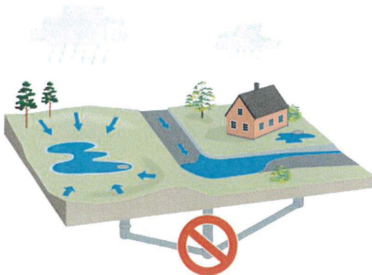
Figur 6. Princip för kartering av lågpunkter och rinnvägar. Ledningsnätets kapacitet räknas inte in. Figuren är hämtad från MSB's vägledning för skyfallskartering (MSB, 2017)
